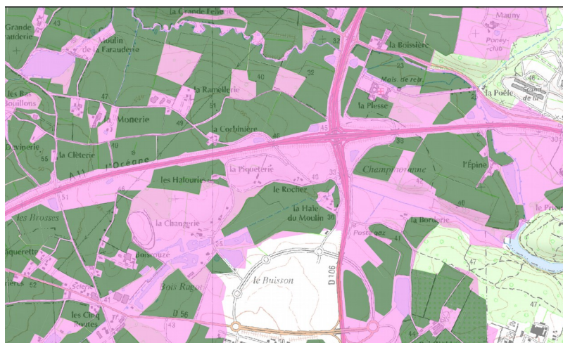
Figure 1 : Emprise des enveloppes dessinées autour des routes, autoroute et voies de chemin de fer de la BD TOPO® (en rose)
